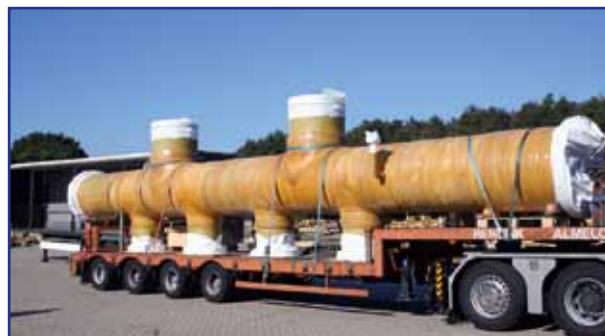
Рис. 3.5. Защищенные концы труб/трубных узлов
